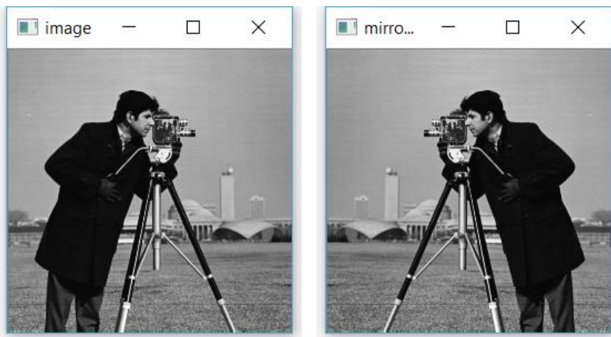
Rys. 4. Obraz z poziomami jasności i jego odbicie zwierciadlane wyświetlone w osobnych oknach przy użyciu funkcji z pakietu opencv
