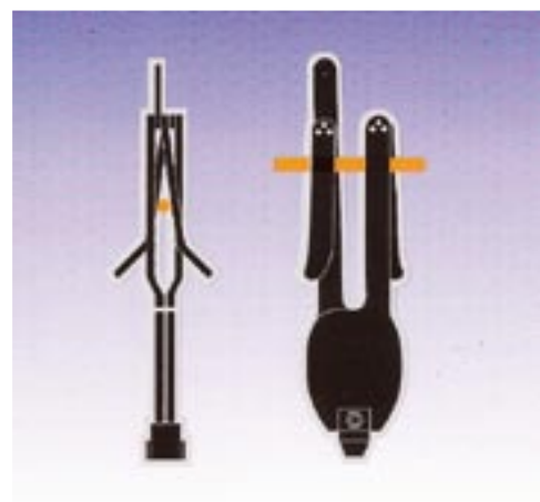
Rys. 3. Zacisk typu TULIPAN na uziemianym przewodzie
